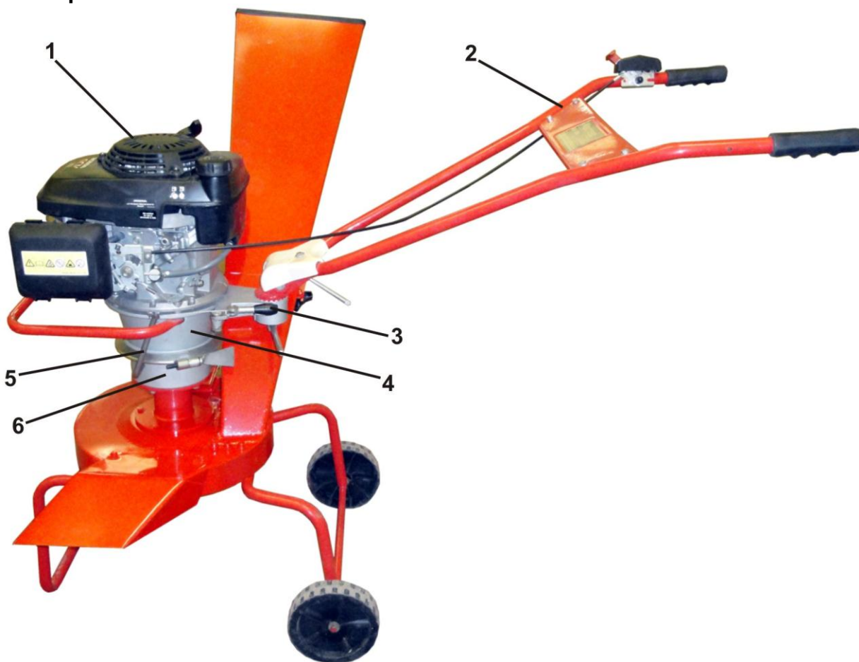
Рис. 2. Измельчитель ИМ-1 с силовым агрегатом мотокультиватора «Мастер»
