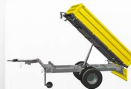
Тележка-самосвал. Грузоподъемность: 1,4 тонны Скорость движения: до 40 км/ч Высота бортов: 0,4 м Наращивание бортов: до 1,2 м (опция) Открывание бортов: 3 стороны
