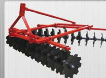
Дисковая борона. Рабочая ширина прохода: 1,5 – 1,7 м Вес: 240 – 260 кг Глубина обработки: 10 – 14 см
