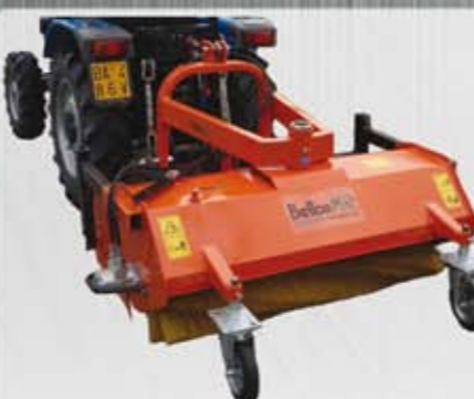
Щетка для заднего вала отбора мощности. Ширина обработки: 1,2 – 1,5 м Вес: 130 – 160 кг
